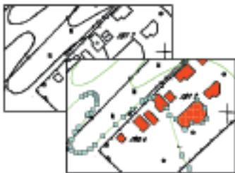
en gardant, effaçant ou lissant l'objet raster d'origine. Wiselimage peut aussi reconnaître les hachures et tracer les courbes raster en polygones. Lors du tracé des polygones, Wiselimage peut détecter automatiquement la direction de tracé la plus probable. On peut tracer des images monochrome, couleur et niveaux de gris.
