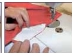
Possibilité d'assemblage de 2 voiles imprimées avec maille occultante pour un rendu recto-verso
